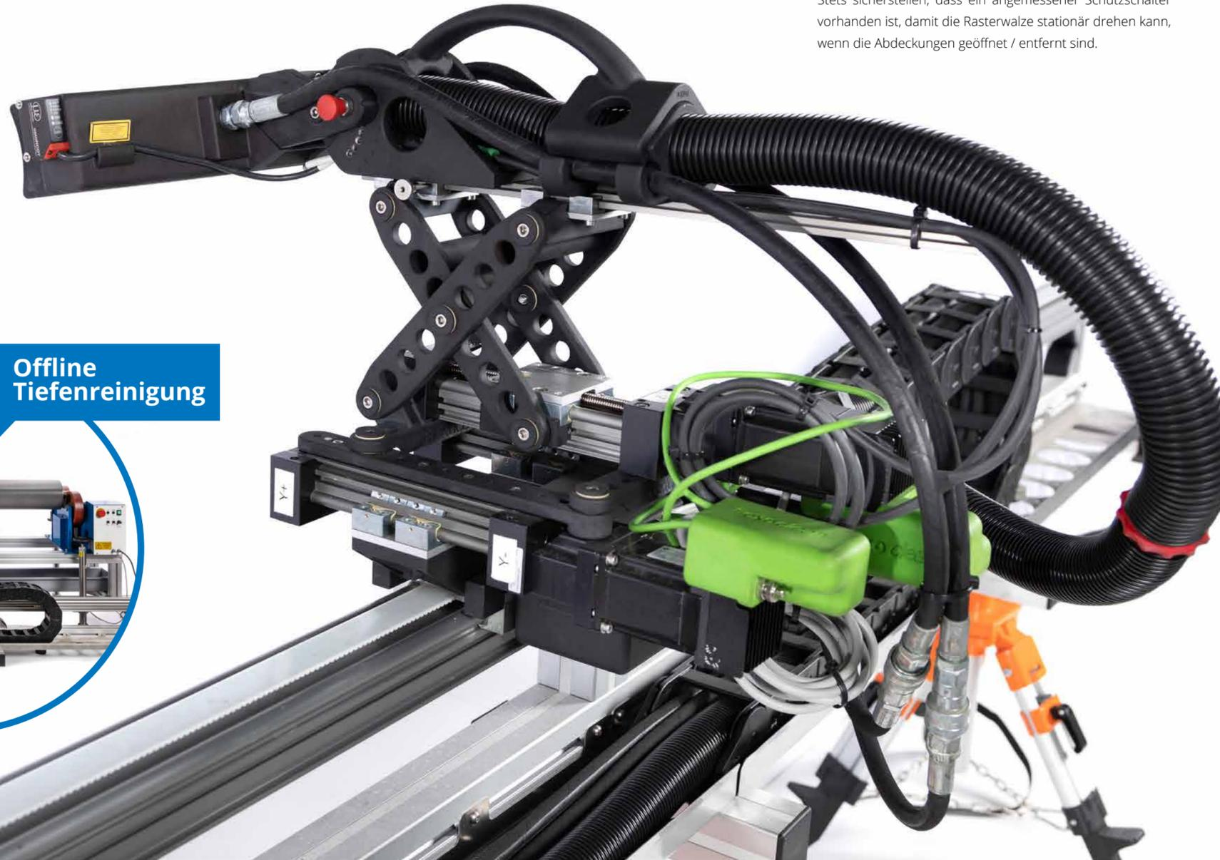
Durch die automatische Positionierung des Kopfes wird die Reinigungsflüssigkeit aufgebracht. Der Kopf sprüht mit Hochdruck die gelöste Farbverunreinigung aus den Zellen und saugt diese gleichzeitig ab. Während des Reinigungsprozesses bilden sich keine Dampfnebel. Das passende Reinigungsmittel für die Deepwave ist von Flexoclean Engineering B.V. entwickelt worden.
